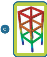
c) Desplazamientos de la estructura
